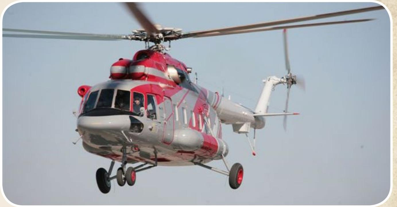
**Mi-8AMT** es un helicóptero de configuración de monomotor con rotor de cola. Grupo propulsor incorpora dos motores turboeje TV3-117VM serie 02 equipados con sistema de protección contra polvo.
