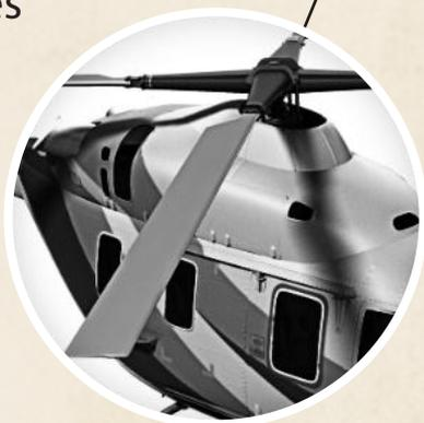
Palas del rotor principal y rotor de cola son de materiales compuestos
