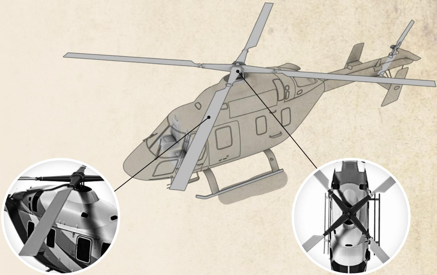
Palas del rotor principal y rotor de cola son de materiales compuestos
